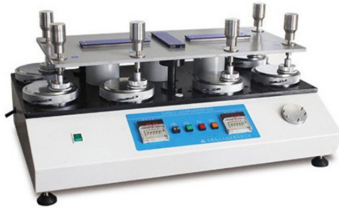
**YG502S织物起毛起球仪（圆轨迹法）适用范围** 用于各类织物的作圆轨迹法起毛起球性能试验。 **仪器特点** 1. 采用工业级彩色触摸屏显示、控制，友好的人机界面简单易用，起毛及起球分两行设置次数，分开控制，操作定制方便。中、英文显示可转换。 2. 采用独特的机械结构设计，起毛及起球试验的转换无需抬起组件，提高了工作效率并降低了操作强度。 3. 滑动机构采用静音直线导轨和滑块，在运行中更加平稳，有效降低了运行噪音。 4. 磨头及砝码等均采用304不锈钢材料加工，表面美观不生锈。 5. 采用符合新行业标准FZ/T 98022-2021规定的毛丛总数为213个的标准毛刷，并在出厂前经过预磨处理，在试验过程中试样稳定地均匀受压刷磨，从而确保了试验结果的准确性。 **适用标准** GB/T4802.1□DIN53863.2等相关标准。
